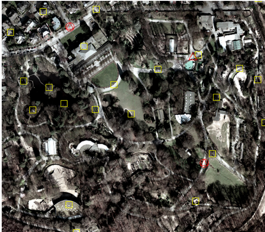
Abb. 5.12 Ausschnitt aus der Übersicht der Verknüpfungs- (gelb) und der Passpunkte (rot)
