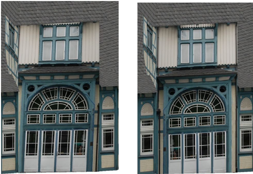
Abb. 6.6 Vergleich: schiefe (links) und gerade (rechts) Texturierung
