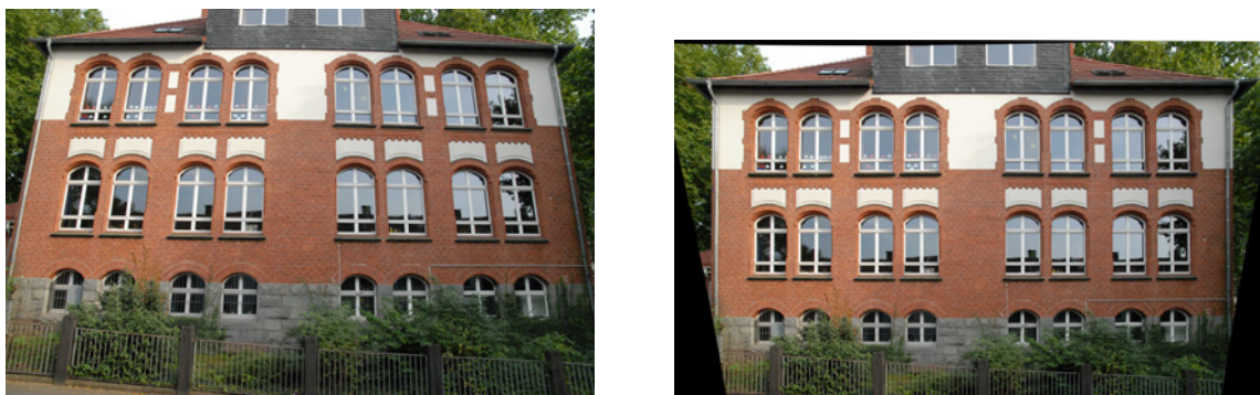
Abb. 6.4 Verzerrte (links) und entzerrte Aufnahme (rechts)
