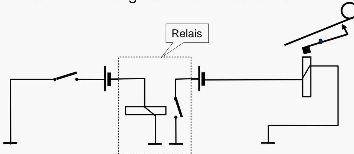
Relais trennen die Stromkreise von Sender u. Empfänger und erleichtern den Zusammenschluß mehrerer Sende- u. Empfangsstationen.
