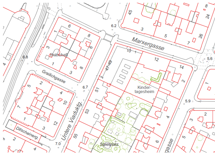
Bild 3: 2D Gebäudedarstellung in der digitalen Mehrzweckkarte der Stadt Wien (Bildquelle: Magistratsabteilung 41, Wien)
