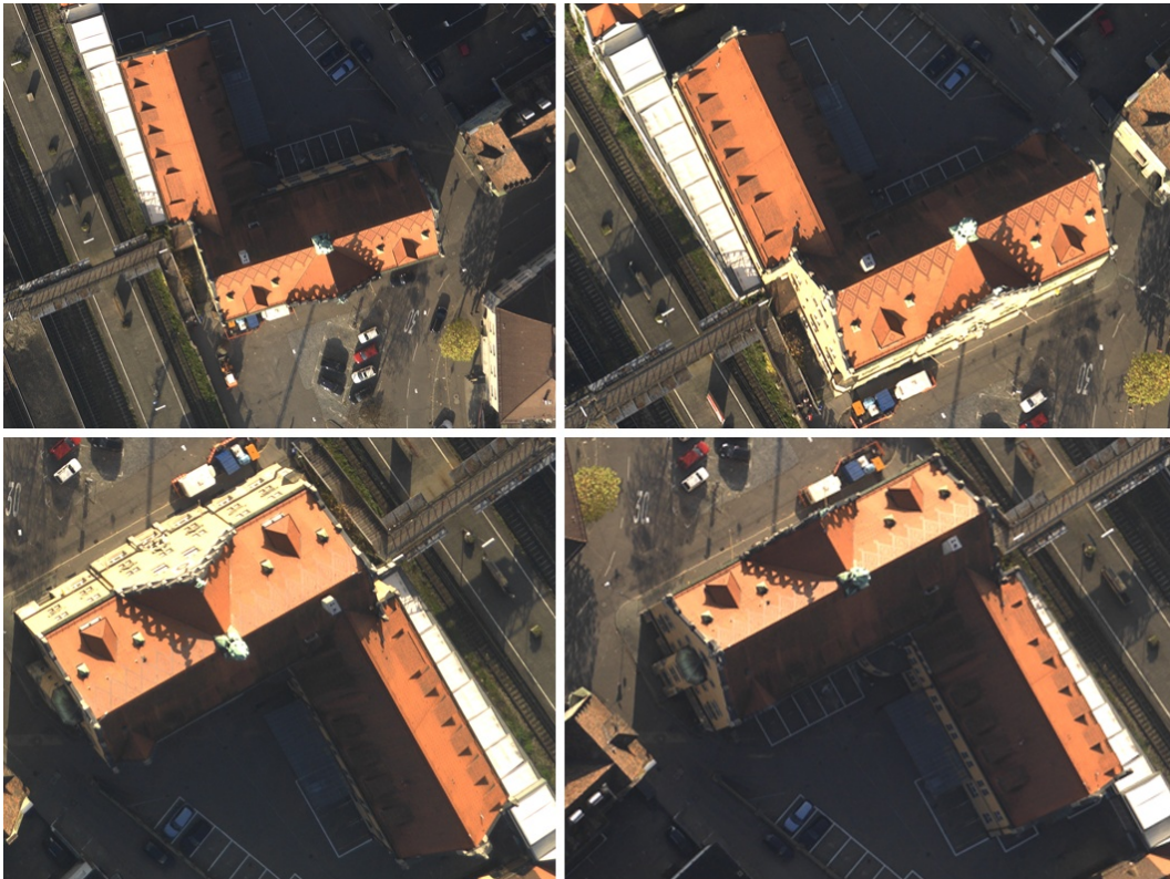
Bild 7: Abbildung eines Gebäudes in mehreren verschiedenen Luftbildern. Eine zumindest 4-fache Überdeckung ist Voraussetzung für den Einsatz automatischer Verfahren.
