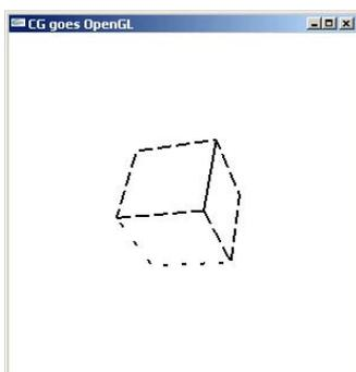
Der abgebildete Würfel (Abb. li.) enthält zwei Linien-Muster, die einzelnen Flächen zugewiesen werden.
