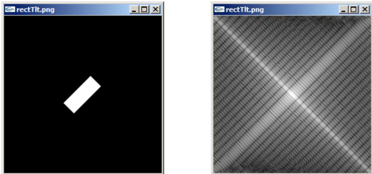
Abb. 1 DIPintro.exe Bild und sein Fourier-Spektrum (logarithmische Darstellung)
