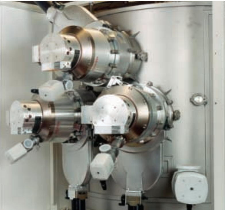
Brillenglas-Beschichtungsanlagen Erzeugung von Anti-Reflexionsschichten auf Linsen. CompactTurbo TPH 2101, Drehschieberpumpe DUO 65 und Ventile EVB 100, EVB 040. Satis, Italien
