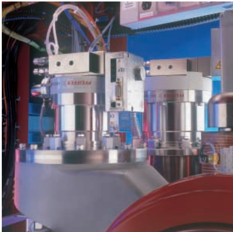
Ionenimplantationsanlagen Dotierung von Halbleitern. Die zu dotierenden Atome werden ionisiert, beschleunigt und auf das Halbleitertarget geschossen. Zwei CompactTurbo 521 Pumpen. Varian Semiconductor Inc., USA
